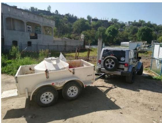
*Tanque transportador para el traslado de peces.*
